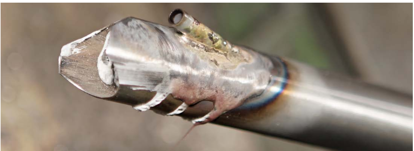
7.) Röhrchen zur Innenverlegung der Züge
