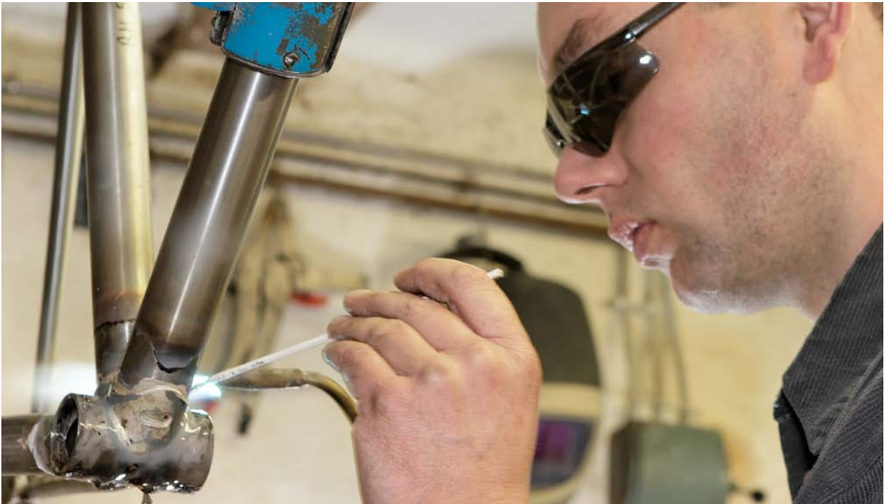
6.) Höhepunkt: Volllöten des Stahlrahmens
