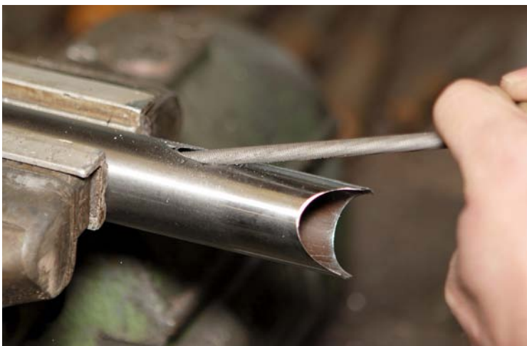
3.) Feilarbeiten am Eingangsloch für die Innenzugverlegung
