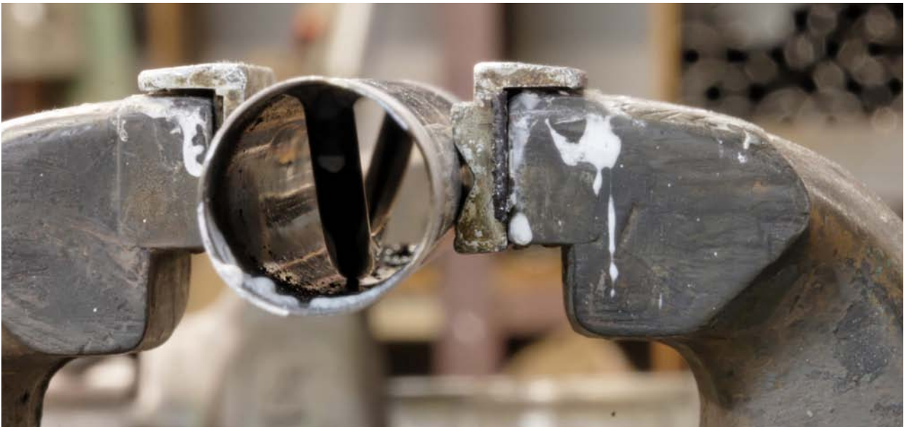
2.) Aufwändige Handarbeit: in das Rohr eingelötetes Stahlröhrchen für die Innenzugführung
