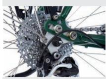
>>> Das spezielle Ausfallende dient als Kettenspanner, falls eine Nabenschaltung verbaut wird.
