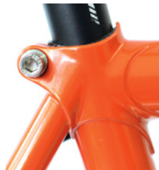
Einfach schön: von Hand gelötete Mikrofusionsmuffe integrierter Sattelklemmung
