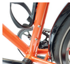
Äußerst beständig: Der Rahmen ist pulverbeschichtet und am Sattelrohr mit Extra-Osen bestückt
